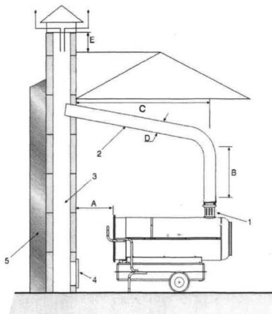
D Равно или больше диаметра трубы-переходника **теплогенератора**
